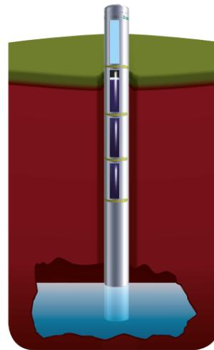
> Un piézomètre est un forage qui permet la mesure du niveau de l'eau souterraine en un point donné de la nappe phréatique ainsi que des prélèvements d'eau.
