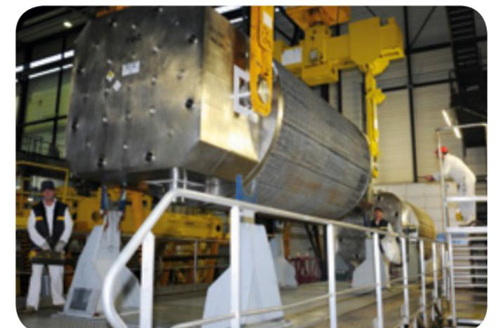
> Mise en place d'un emballage sur un chariot de transfert dans les ateliers.
