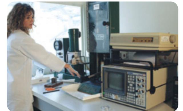
> Recherche des émetteurs alpha et bêta-gamma dans les mouchoirs après suspicion de contamination.
