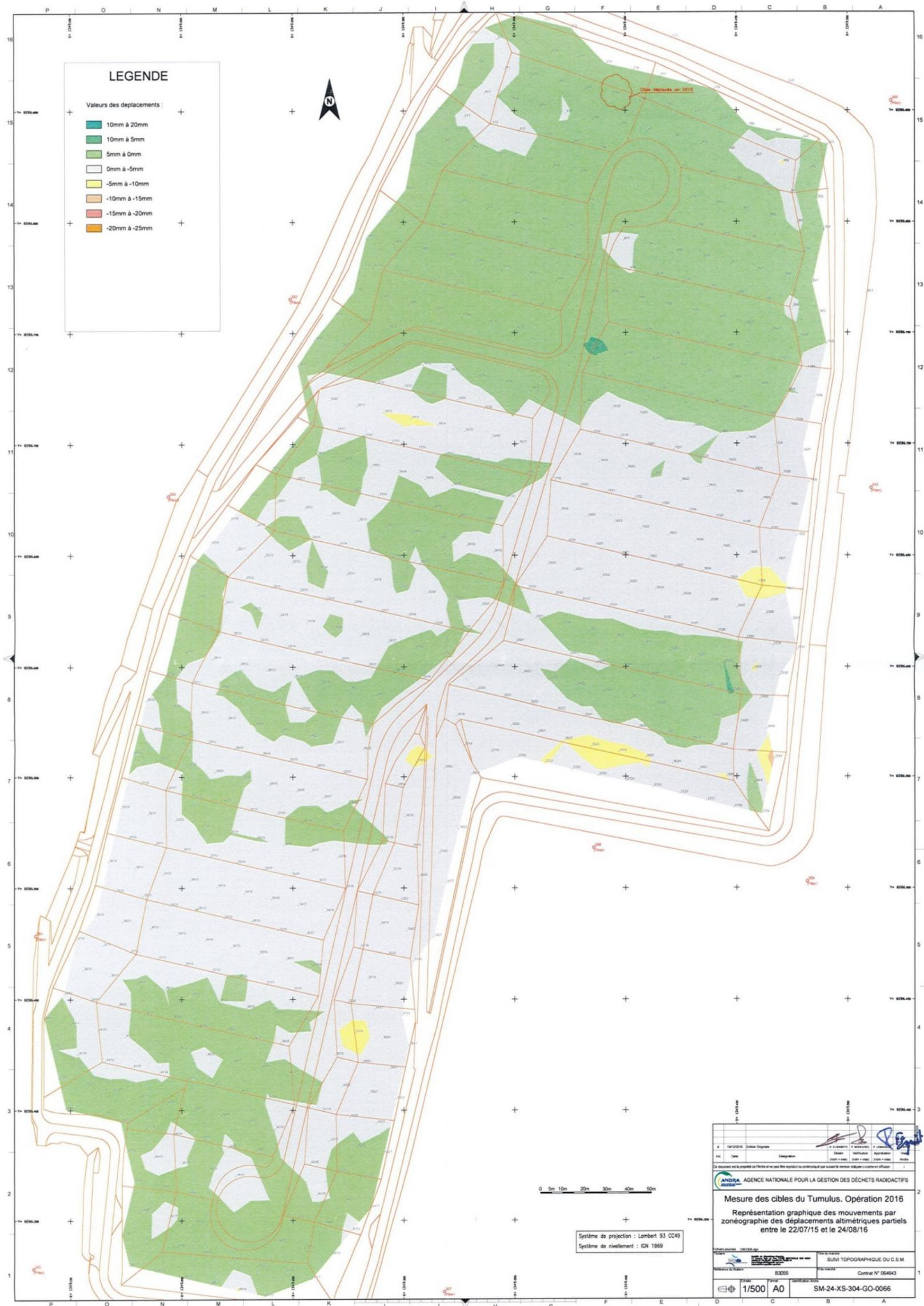
Figure 3-5 Zonéographie des déplacements altimétriques entre le 22/07/15 et le 24/08/16
