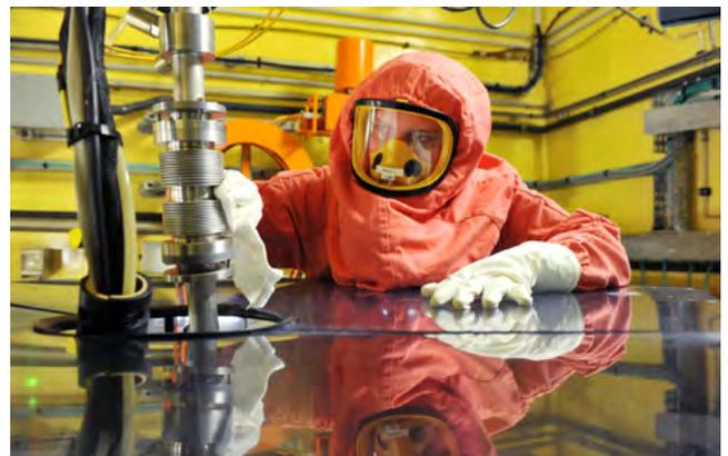
Contrôle de contamination sur un banc de prise d'échantillon.
