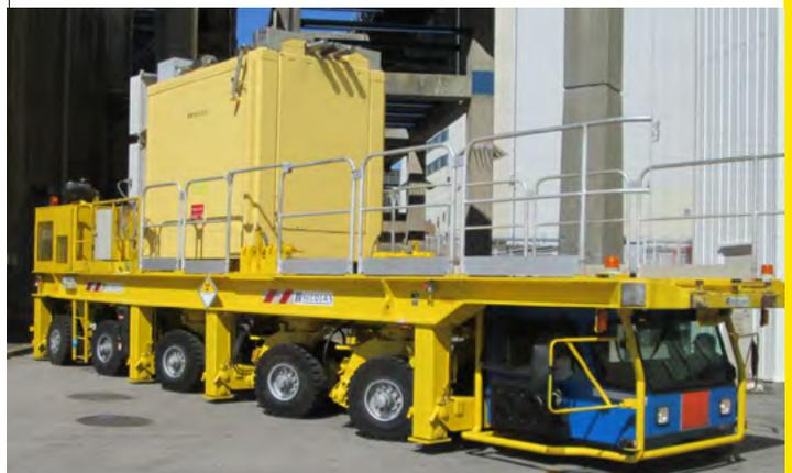
Navette de transport inter-atelier pour les fûts de coques et embouts
