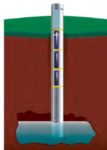
Un piézomètre est un forage qui permet la mesure du niveau de l'eau souterraine en un point donné de la nappe phréatique ainsi que des prélèvements d'eau.
