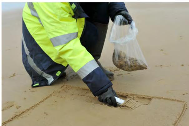
Prélèvement de sable pour analyse.
