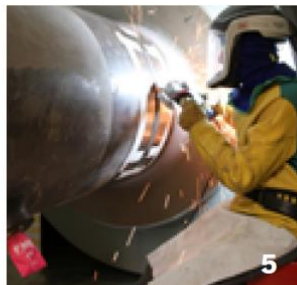
5 Préparation de la surface via un arasage
