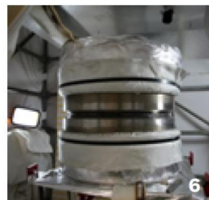
6 Coupon-témoin représentatif d'une soudure
