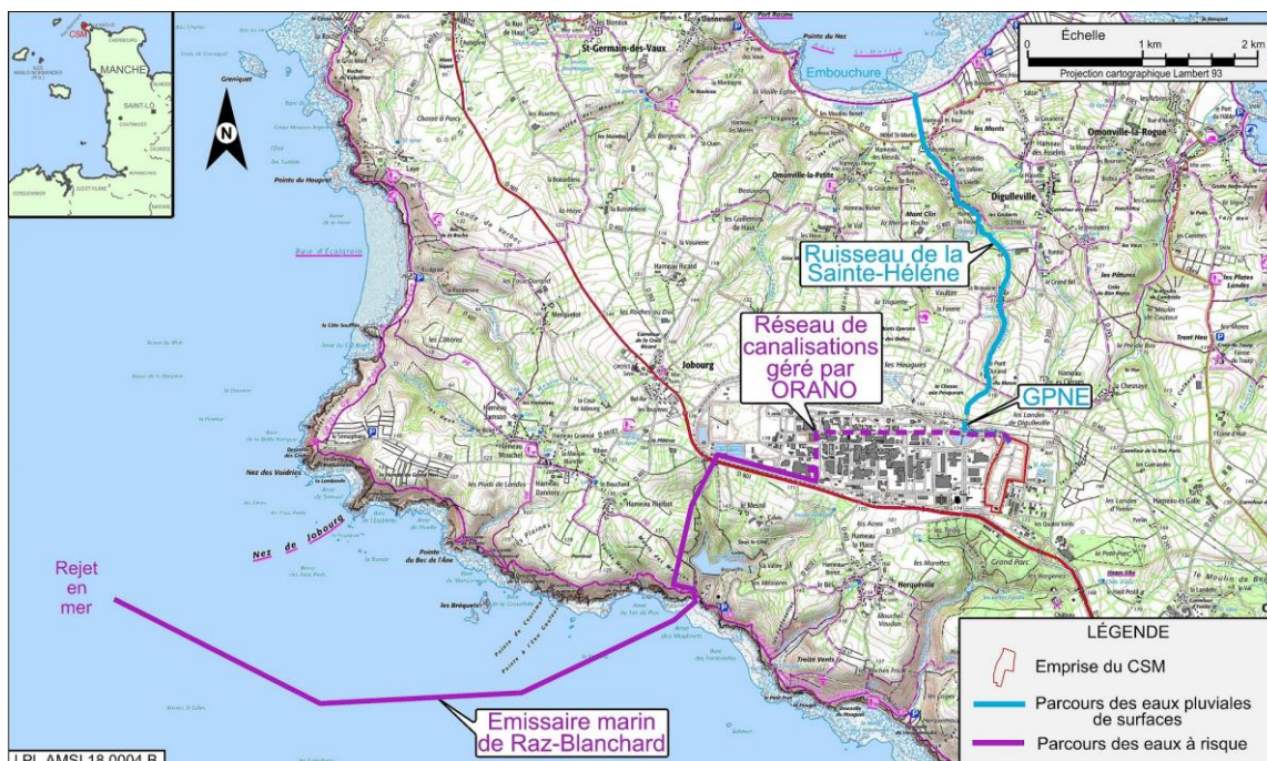
Figure 4-11 Schéma des rejets des effluents du CSM dans l'environnement
