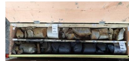
Carottage incliné à 45° pour la recherche de la faille
